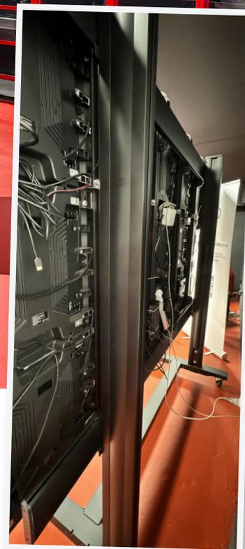
L'area polifunzionale vicino alla zona ristoro della pista è dotata di un ledwall di 2,5 x 1,5 metri che ha la particolarità di essere montato su un carrello prodotto da Vogel's. Questo carrello (anche nel particolare) è una struttura disegnata ad hoc per le esigenze del cliente che rende il ledwall spostabile e semplifica l'assemblaggio delle mattonelle.
