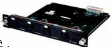
M-DL-AIN-A cod. M-DX-IN-A DX32 Mic/line input module - 8 preamps con ingressi analogici XLR.
