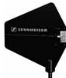
A 2003 UHF Antenna passiva direttiva cod. 3658531 Antenna passiva direttiva aperiodica per tutta la banda UHF (450-960 MHz), guadagno 4 dB, angolo d'apertura \pm 50^\circ , connettore BNC.
