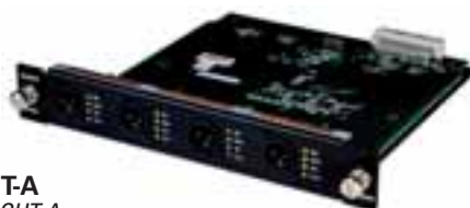
M-DL-AOUT-A cod. M-DX-OUT-A DX32 Line output module - 8 uscite bilanciate analogiche di linea su XLR.
