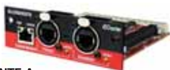
M-DANTE-A cod. M-DANTE-A Scheda Dante 64ch con dLIVE necessita di adattatore M-DL-ADAPT-A.
